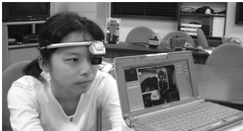
図 1: LED の VCC マーカを身に付けたユーザの例
