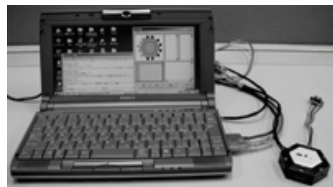
図 2: ユビキタスチップと PC の接続例
